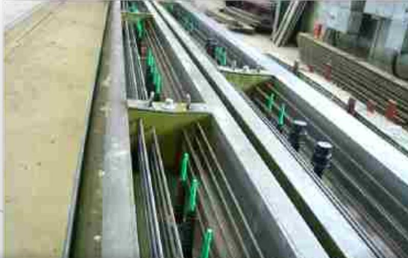
Distribución del cable de tensado
